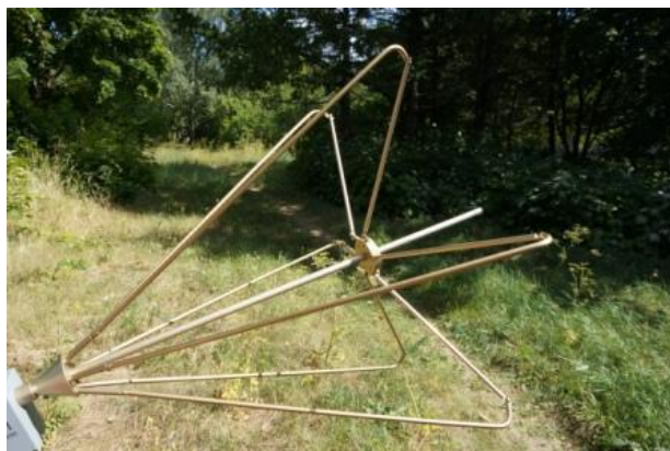
Фото 4. Антенна П6-121 на стадии сборки
