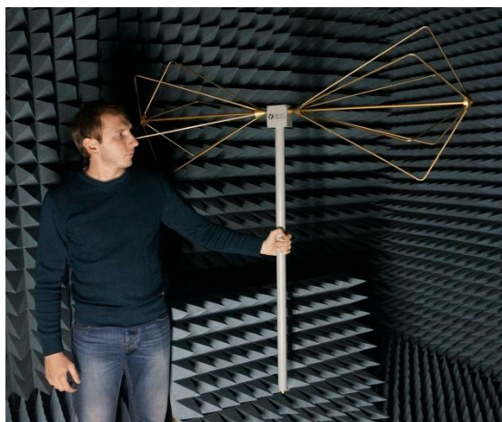
Фото 3. Антенна П6-121 Спец. исполнение для работы в полевых условиях и на мачтах
