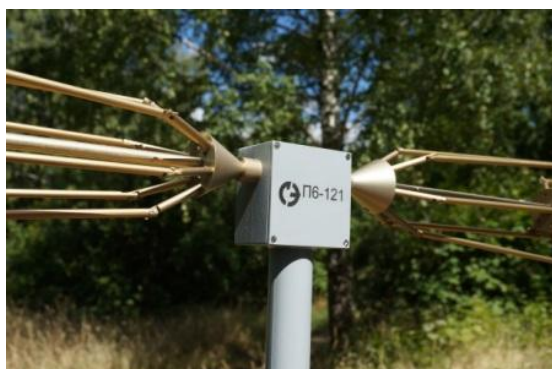
Фото 5. Антенна П6-121, центральная часть с вибраторами
